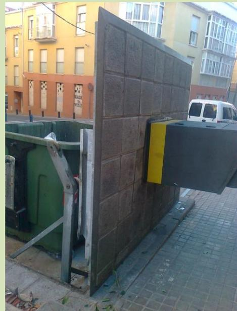
El sistema de elevación está compuesto por una bomba hidráulica y un motor, accionado por dos baterías. Estas baterías son cargadas por un regulador de carga que recibe energía de un panel solar fotovoltaico fijo. Dependiendo del entorno de los distintos emplazamientos, los paneles están orientados hacia una u otra dirección.
