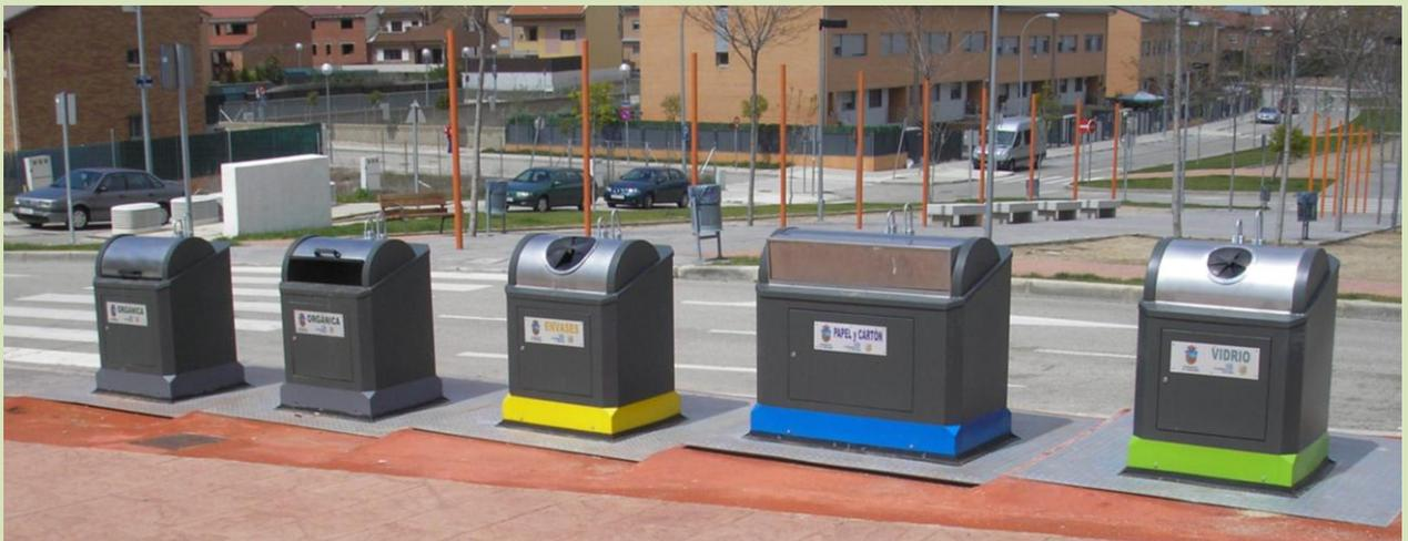
En la parte superior de los buzones hay dos anillas. Una de ellas es fija y se utiliza para elevar el contenedor con un medio externo (una grúa incorporada en el camión recolector), la otra permite con su desplazamiento vertical la apertura de las compuertas inferiores del contenedor para su descarga una vez está fuera de su emplazamiento.
